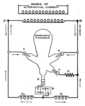
Fig. 65. Mercury Arc Rectifier
